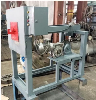
Рисунок 8. Установка для извлечения БК из шин легковых автомобилей
